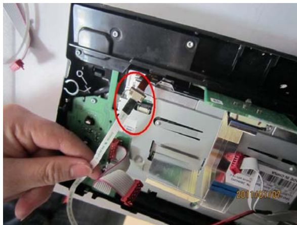
5. 我们金色线连接的标明 1 的连接头和原车金色触摸线 1 连接。
