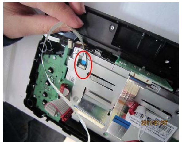
6. 我们金色线标明 2 的线和原车触摸接头 (图 3) 标明的 2 连接
